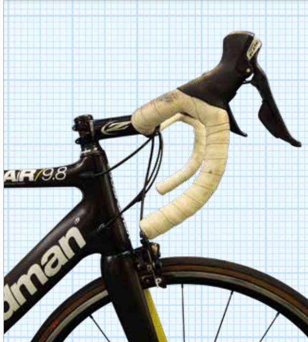
▶ Nieprawidłowy kąt nachylenia dźwigni hamulca
