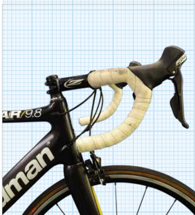
▶ Prawidłowy kąt nachylenia dźwigni hamulca
